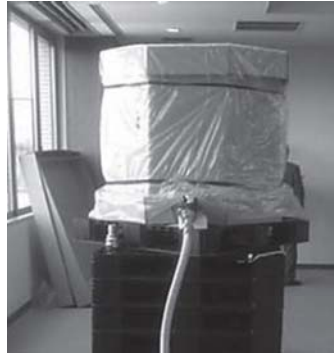
1トンの貯水が可能な 強化ダンボール製の貯水槽
